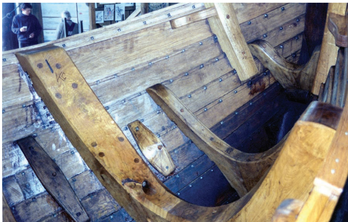
Förtöjningsanordning samt rong och spant i krappet i aktern. Närmast syns roderspantet under inpassning. Nedan: Roderspantet monterat. Hålet för rodervidjan upptaget. Två träklampor på insidan förstärker infästningen av den utanför sittande rodervårtan. Foto:SVS
