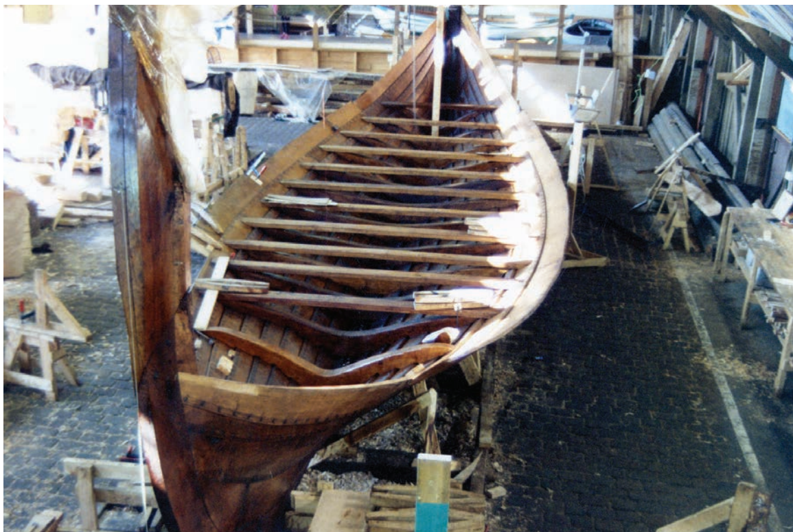
Det skarpa skäret i fören under vattenlinjen och det breda utlägget mot skeppets mitt framträder. Foto: SVS
