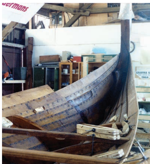
Bord nr 9 på babords sida växer fram mot stäven. Det översta av hakborden med inlaskat bord nr 6 syns i bogen. De starkt V-formade bottenstockarna nr 14 och 15 är ännu inte på plats. Foto: SVS
