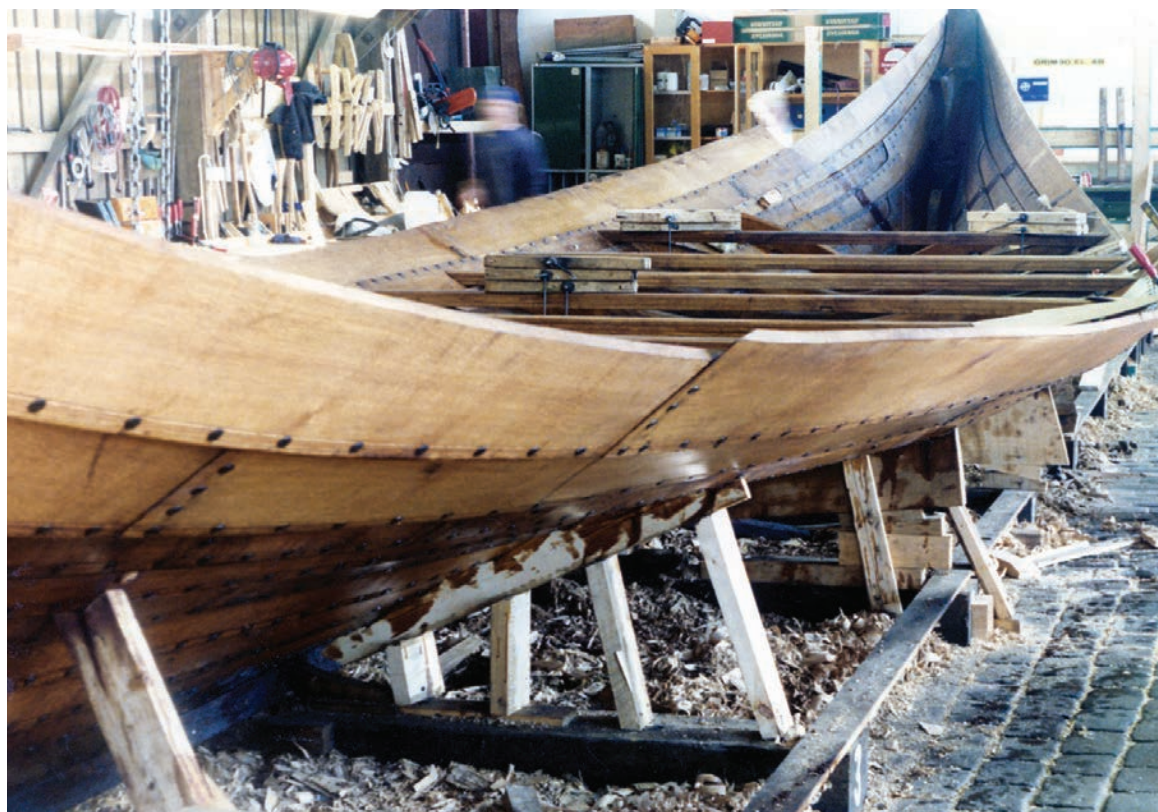
Bordläggningen är relativt tunn. Botten måste stöttas så att skrovformen inte förändras. Foto: SVS.
