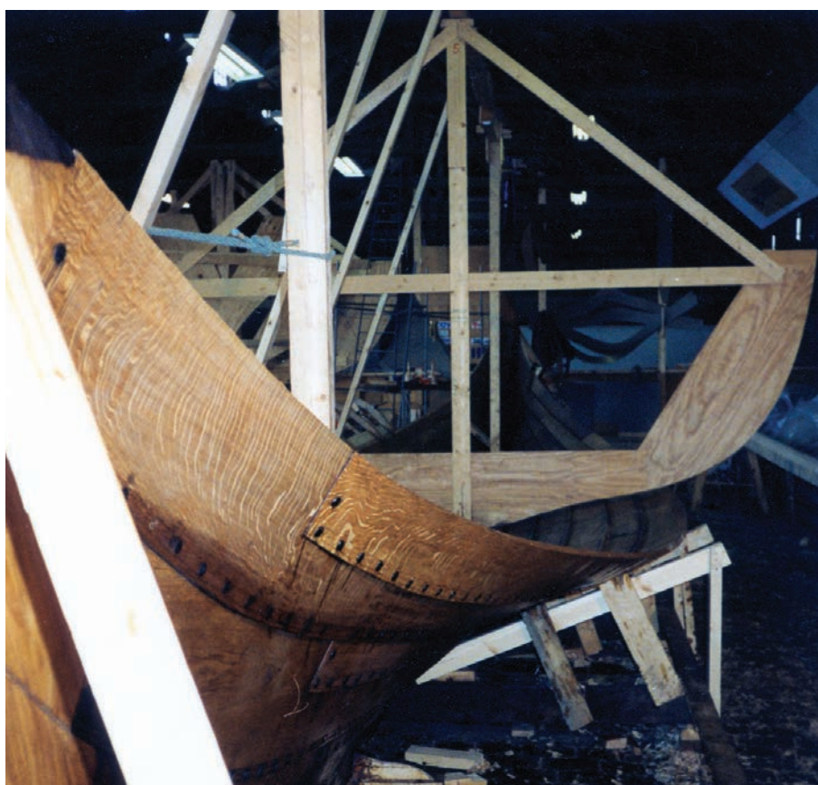
Mastfoten sträcker sig över fyra bottenstockar och är nerfälld över dessa. Vid nr 8 och nr 9 låst med överfall. En gren från mastfoten går upp i den tvärsöver skeppet liggande mastbalken. Utefter sidorna syns de blivande barlastlådorna. Foto:SVS
