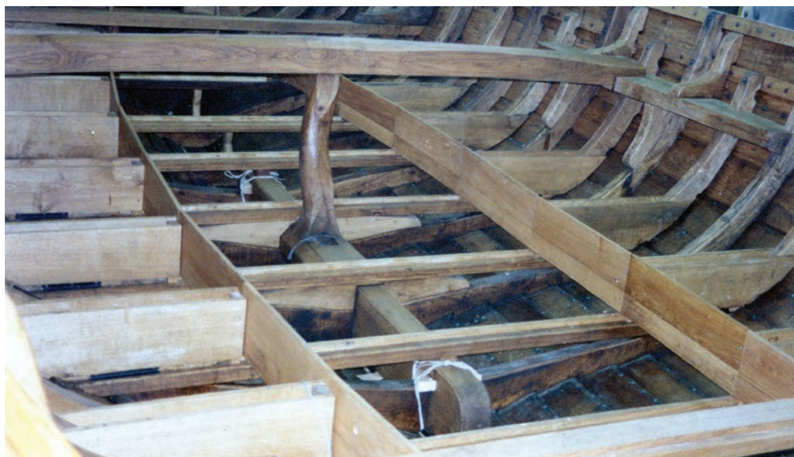
Mastfoten sträcker sig över fyra bottenstockar och är nerfälld över dessa. Vid nr 8 och nr 9 låst med överfall. En gren från mastfoten går upp i den tvärsöver skeppet liggande mastbalken. Utefter sidorna syns de blivande barlastlådorna. Foto:SVS
