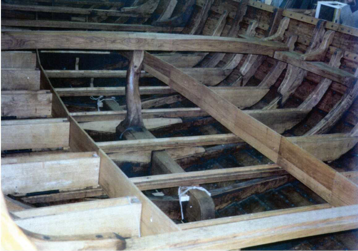
Mastfoten sträcker sig över fyra bottenstockar och är nedfälld över dessa och vid bottenstock nr 8 och 9 låst med överfall. En växt gren från mastfoten går upp i den tvärs över skeppet liggande mastbalken. Utefter sidorna syns de blivande barlastlådorna.
