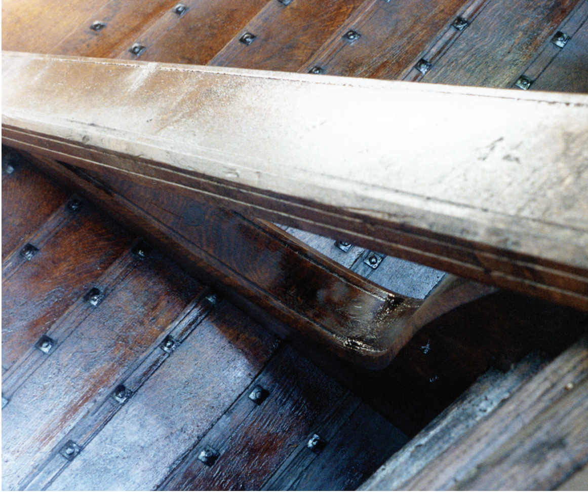
Ett av de V-formade, naturligt växta spanten i fören. Foto: SVS
