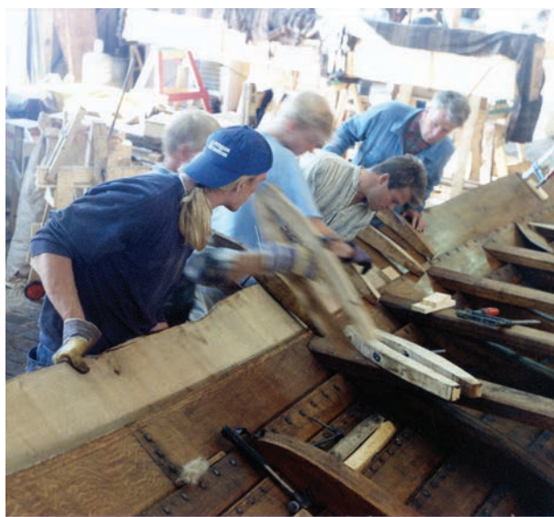
Bord nr 9 på styrbordssidan inpassas. Foto: SVS
