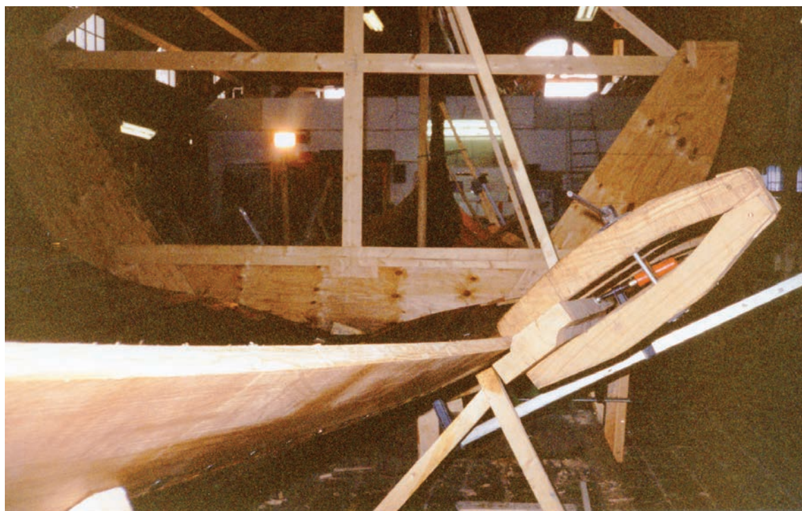
Det 9 meter långa ämnet till det 7:e bordet, meginhufr, klammas till bord nr 6.
