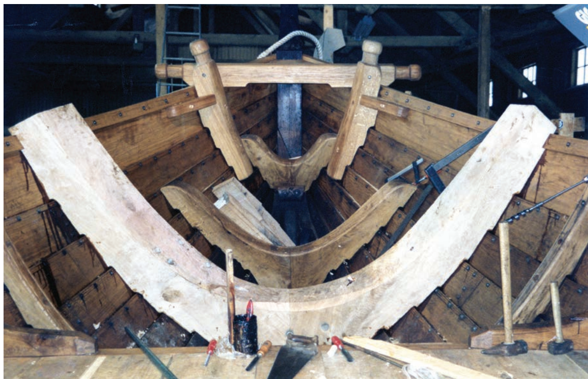
Förtöjningsanordning samt rong och spant i krappet i aktern. Närmast syns roderspantet under inpassning. Nedan: Roderspantet monterat. Hålet för rodervidjan upptaget. Två träklampor på insidan förstärker infästningen av den utanför sittande rodervårtan. Foto:SVS
