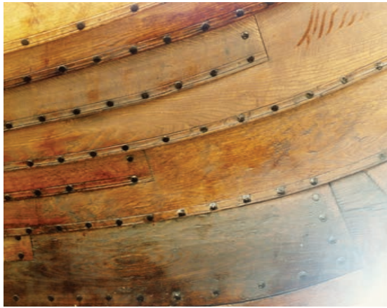
De tre i haken inlaskade borden 2, 4 och 6. Foto:SVS
