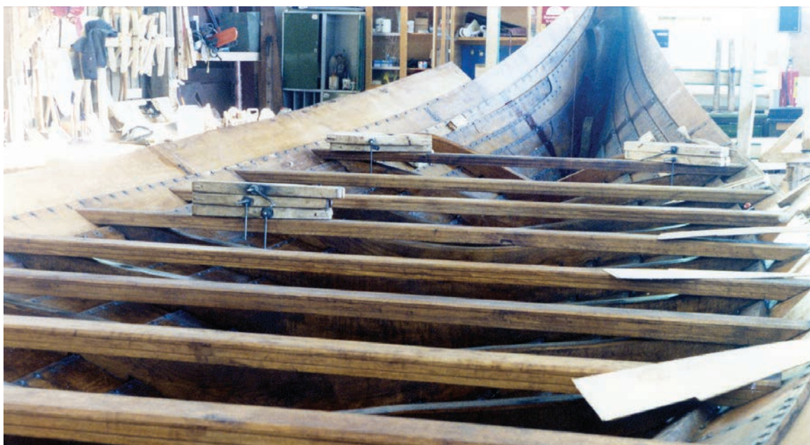
Tvärbalkarna är i ändarna utförda med urtag där bottenstockarnas toppar passas in. Balkarna vilar på topparna och når ned till bord nr 7, meginhufv, men har en spalt på ett par millimeter till bord nr 8. Balkarna har ingen fogning neråt, utan endast med ovanpå stående, fogade knän som ansluts till bordsidan. Foto: SVS
