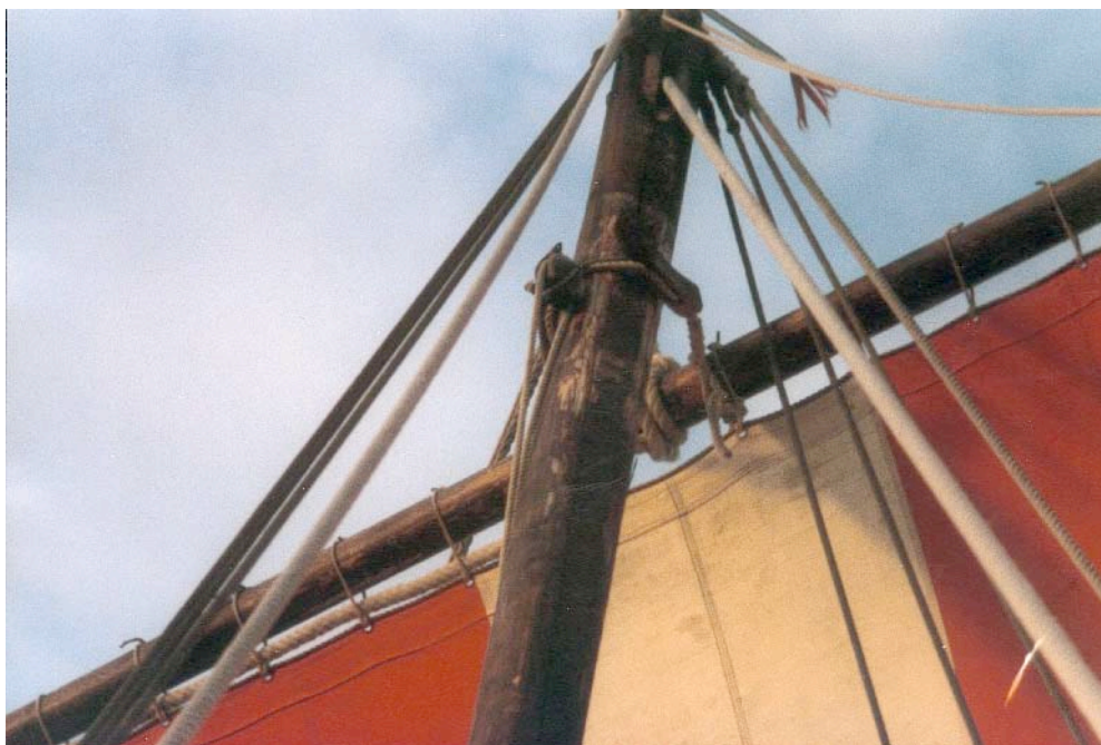
Den trasiga racken ställde till det för besättningen. Det går inte att segla med en trasig rack, så den måste bytas. Foto: Ove Larsson
